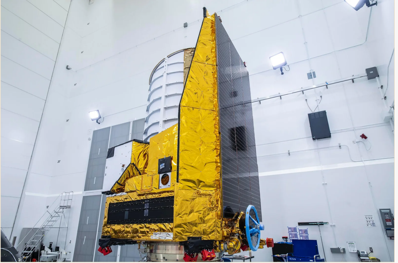
欧几里得太空飞船发射前在洁净室中的照片，一侧有黑色太阳能电池板，白色望远镜筒位于仪器模块上方。
