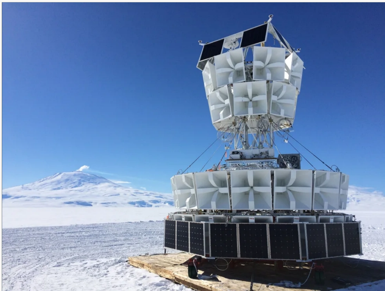
۴۸ آنتن ANITA از روی یک گوندولای ۲۵ فوتی رو به پایین، به سوی یخ‌های جنوبگان نشانه رفته‌اند.
